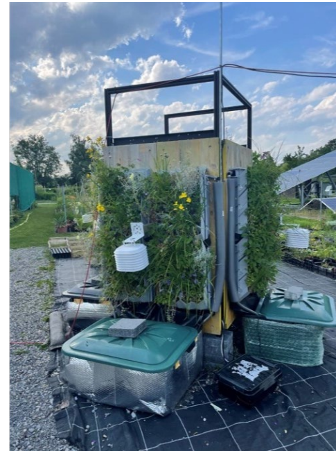
Environ 4 - 8l/min par ex. élimination de la DCO 93%
