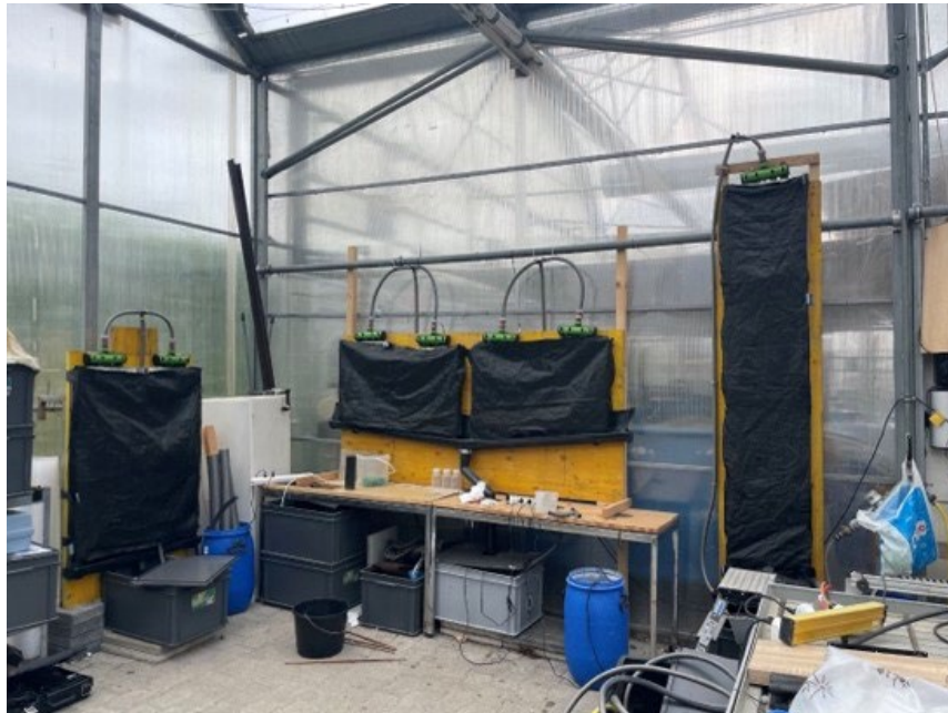
L'orientation verticale semble meilleure par ex. élimination de la DCO 88%
